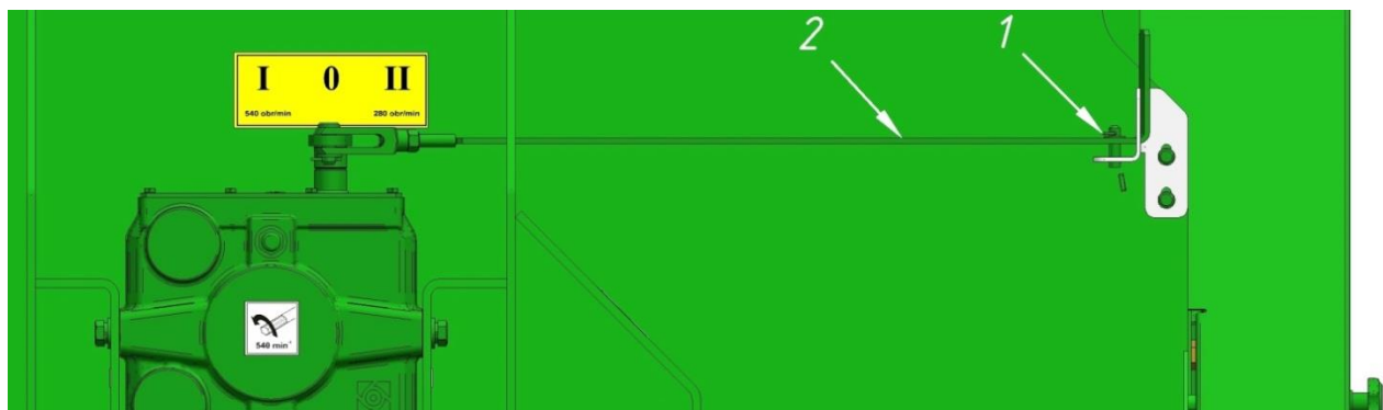
Rys.46 Regulacja prędkości wirnika wyrzutowego.
