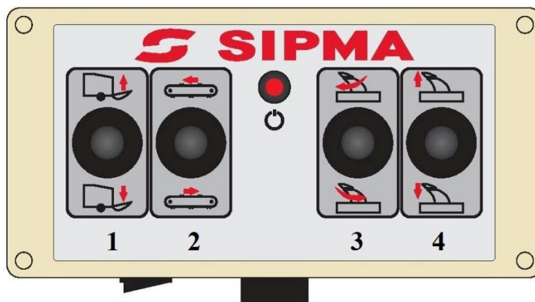
Rys.47 Przyciski sterownika rozdrabniacza bel.
