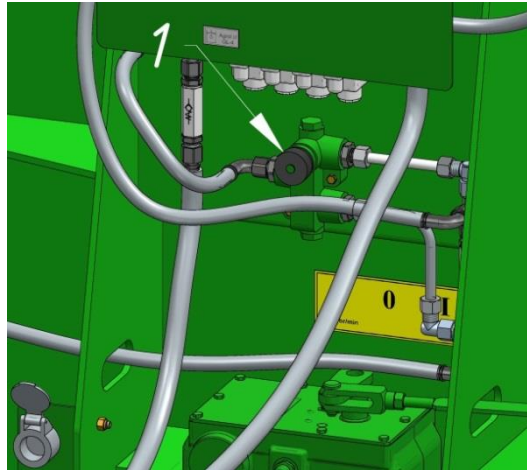
Rys.45 Regulacja prędkości przenośnika podłogowego
